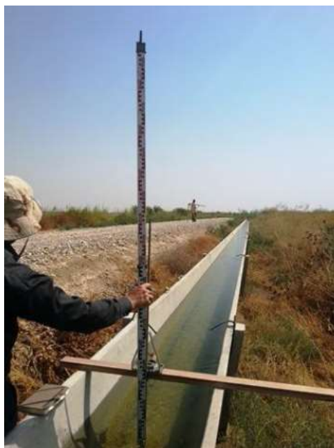
شکل (۳-۱۰): تعیین شیب کف توسط دوربین نیوو
