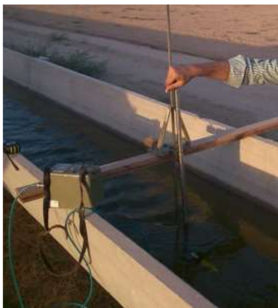
شکل (۳-۱۱): اندازه‌گیری عمق جریان با استفاده از پوینت گیج
