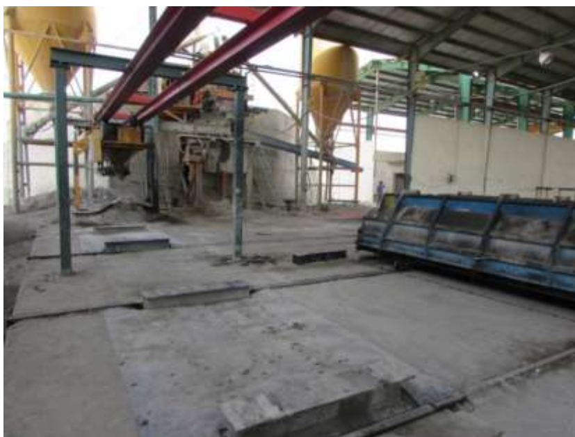
شکل (۲-۲): جام حمل بتن و دستگاه ویبره
