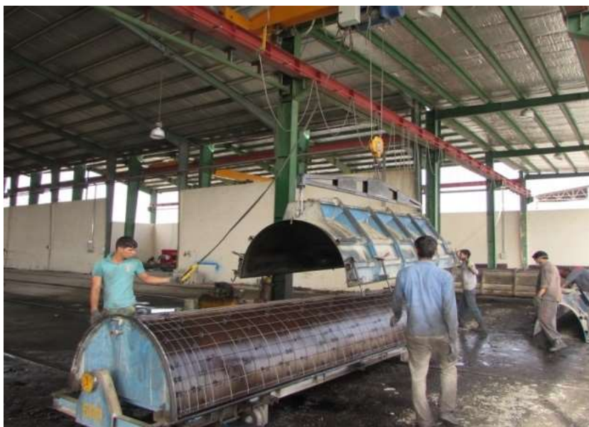
شکل (۳-۳): آرایش فاصله انداز ها بر روی شبکه قبل از بستن قالب بیرونی
