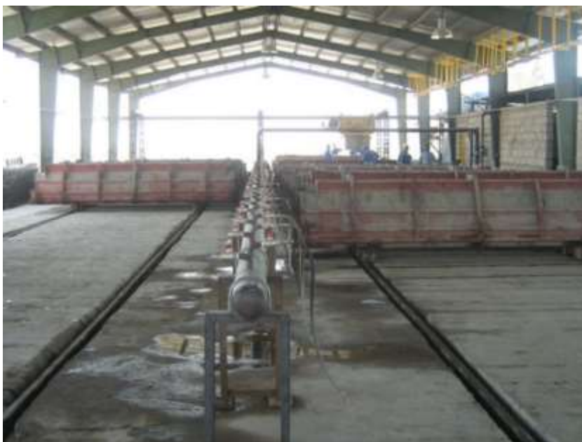
شکل (۳-۲): عمل آوری کانالت‌ها به وسیله بخار آب
