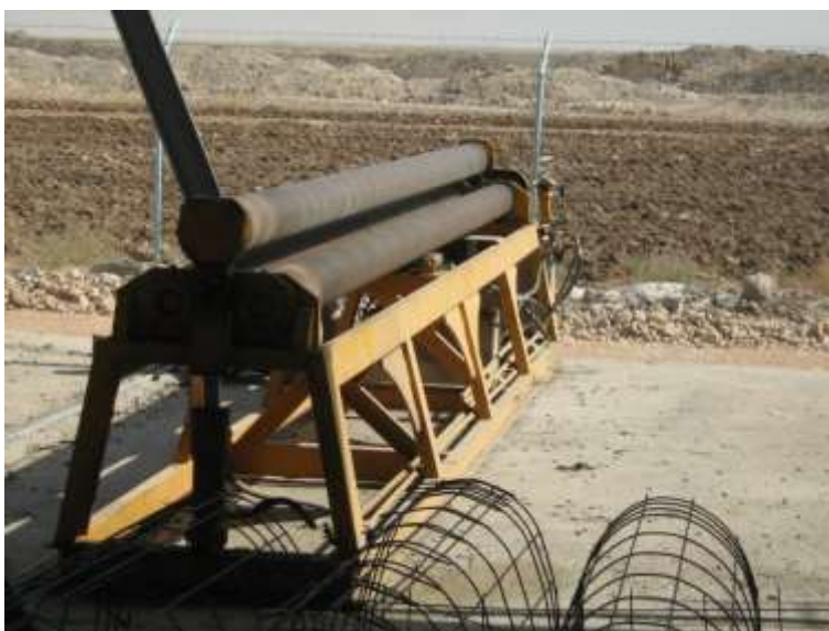
شکل (۳-۲): دستگاه نورد شبکه میلگرد پیش جوش
