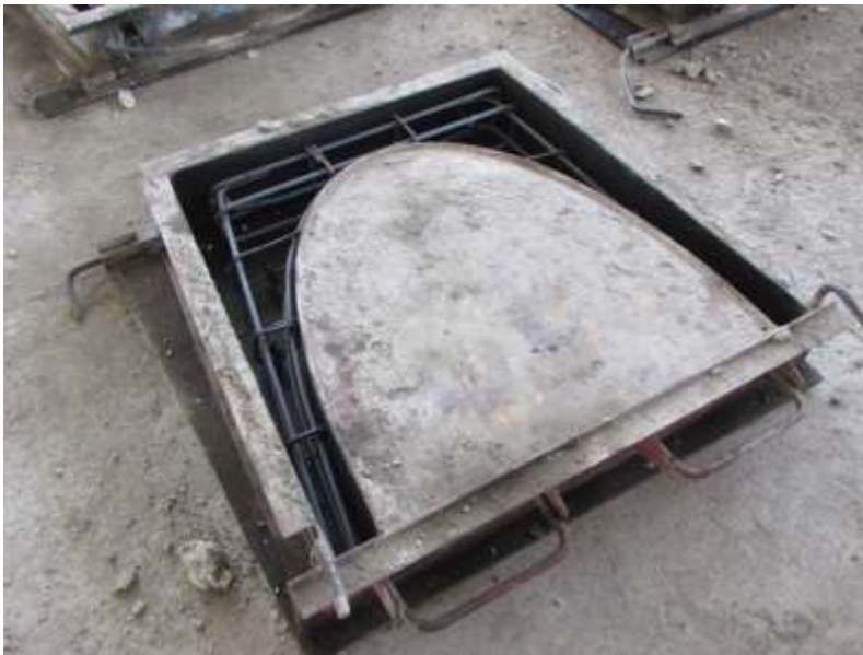
شکل (۲-۶): میلگردهای قرار داده شده در قالب زین
