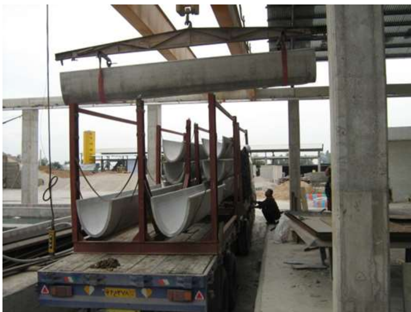
شکل (۳-۷): بارگیری و حمل کانالت به‌وسیله شاهین
