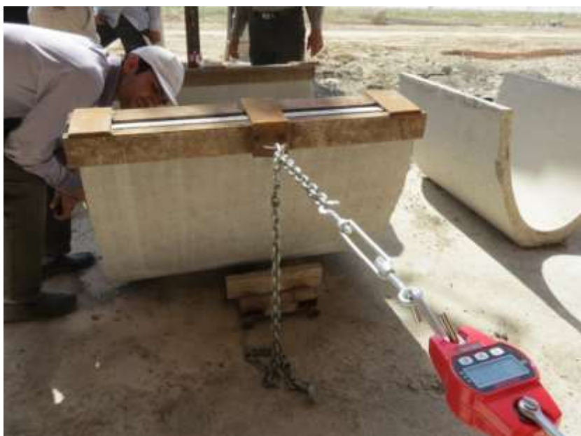
شکل (۳-۹): آزمایش خمشی عرضی و کنترل نمونه
